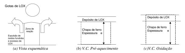
Figura 5. Volumes de controle usados em cada fase do processo.
