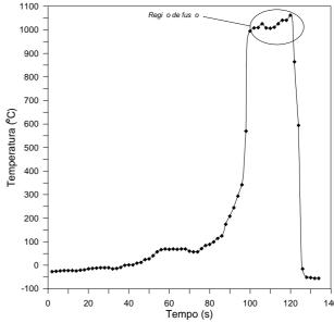
Figura 3. Temperatura medida na face inferior da placa.
