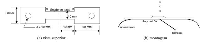
Figura 1. Corpo de prova (chapa com espessura de 1 mm).
