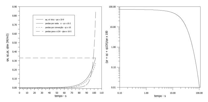
Figura 6. Variação da potência efetiva de aquecimento e das perdas na seção de teste.
