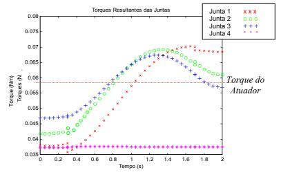
Figura 6. Simulação dos torques.
