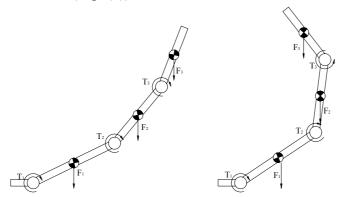
Figura 7. Amplificação de torque devido à massa dos elos.
