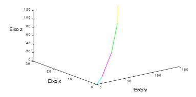
Figura 5. Simulação Cinemática do Dedo Mecânico.
