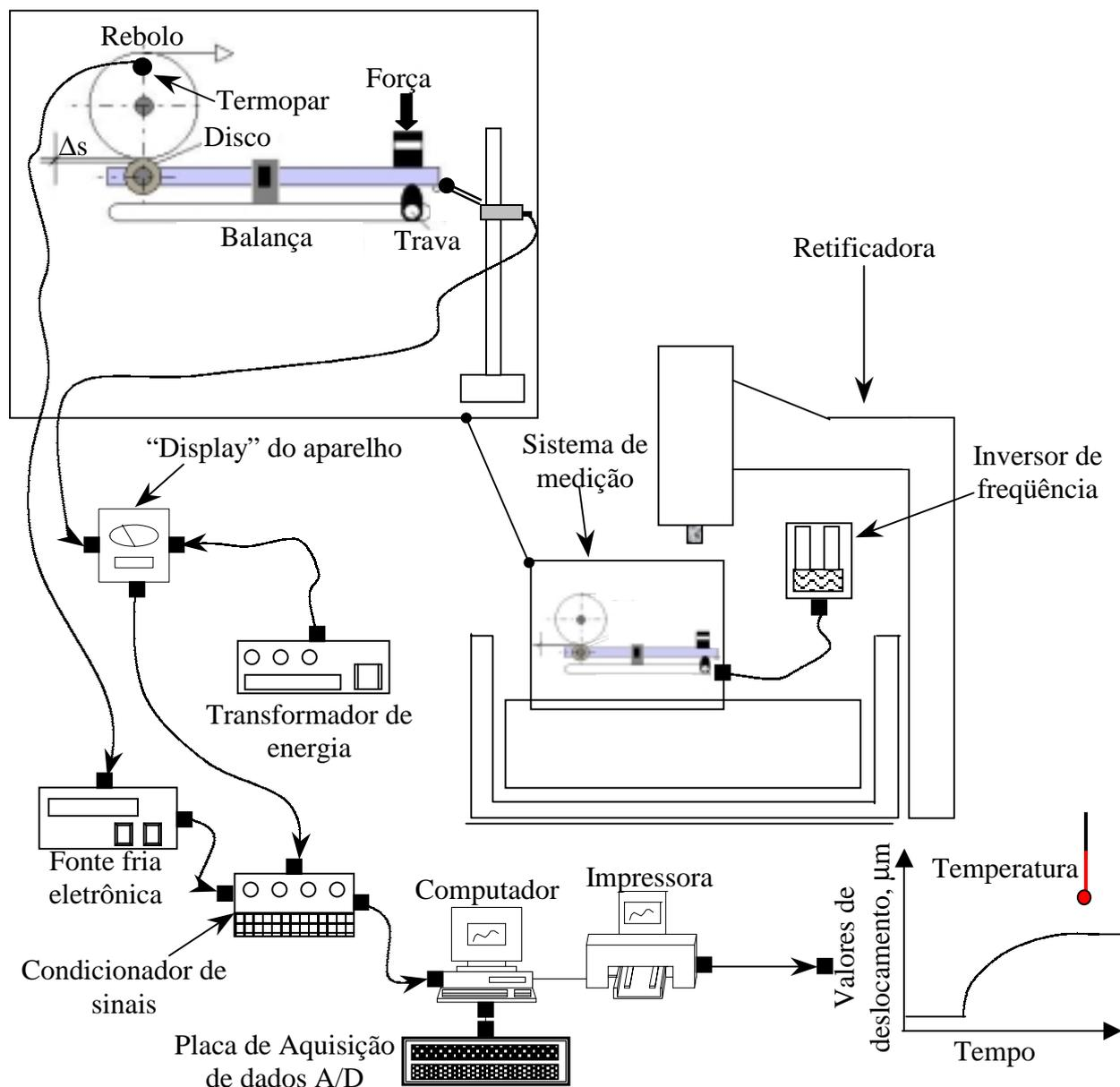
Figura 4. Esquema geral de aquisição de dados do deslocamento vertical da balança
