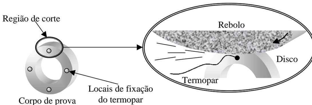
Figura 3. Constituição do corpo de prova e mecanismo de remoção de material
