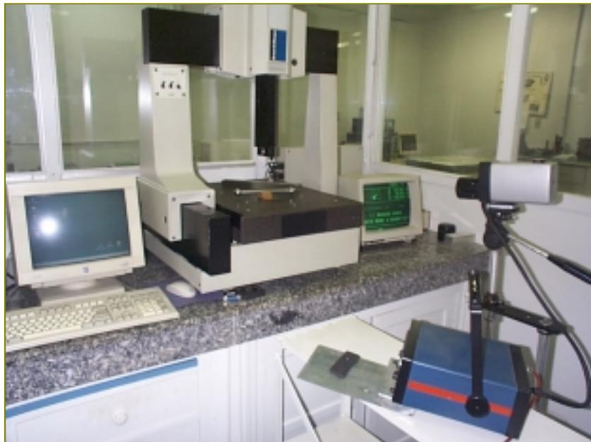
Figura 2. Montagem experimental para determinação dos pontos quentes da estrutura.
