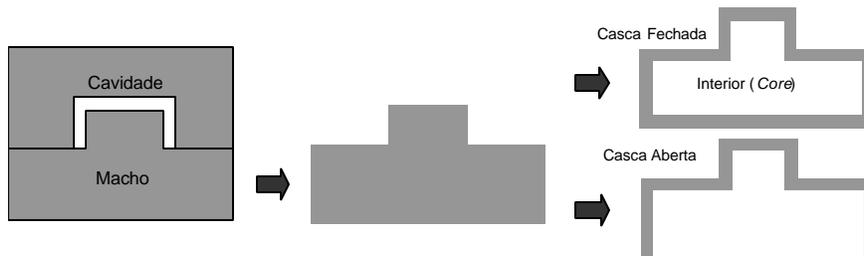
Figura 3. Princípio de casca (*shelling*) aplicado a insertos de moldes
