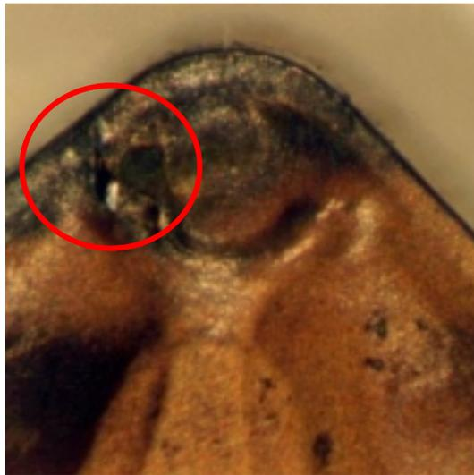
Figura 3. Detalhe do desgaste de entalhe da ferramenta na região de extremidade da profundidade de corte.
