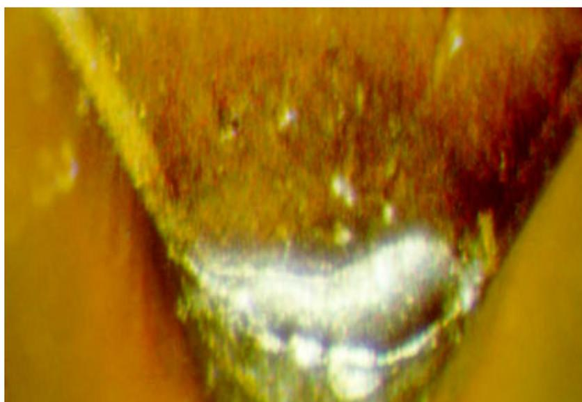
Figura 3. Forma de desgaste da ferramenta de corte para  $v_c = 130\text{m/min}$ ,  $f = 0,07\text{ mm/volta}$  e  $a_p = 0,2\text{ mm}$  aumento de 50 vezes. Neste momento,  $lc = 2925\text{ m}$  e  $V_B = 0,2\text{ mm}$ .
