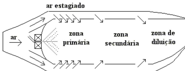
Figura 2. Esquema de uma câmara de combustão evidenciando a zona primária com múltiplos estágios.
