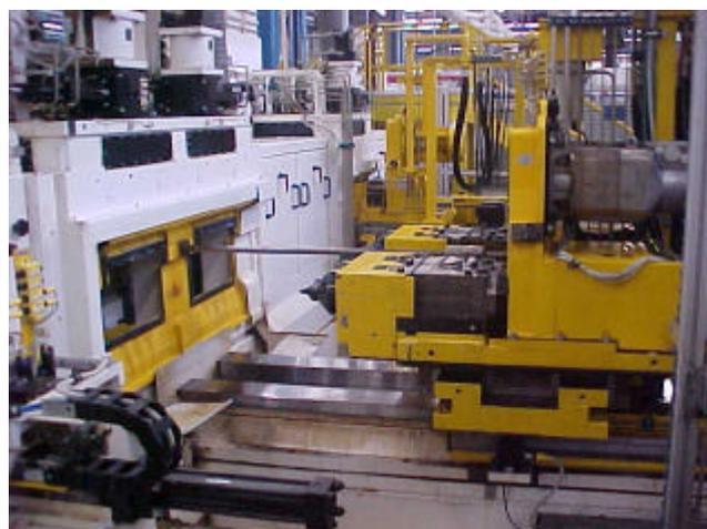
Fig. 2. *Transfer* de usinagem da linha de produção do cabeçote motor 16V.
