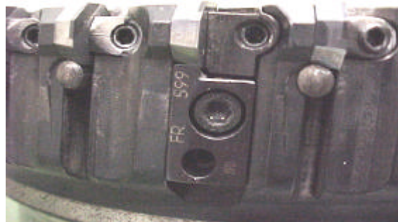
Figura 6. Detalhes do sistema de fixação e de regulagem dos insertos.
