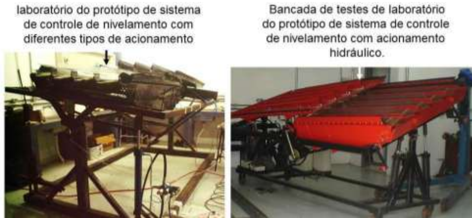
Figura 7 – Fotografia mostrando a bancada construída para os testes do protótipo da unidade de controle automático de nivelamento por diferentes acionamentos (hidráulico, pneumático e elétrico) e posterior avaliação em laboratório.
