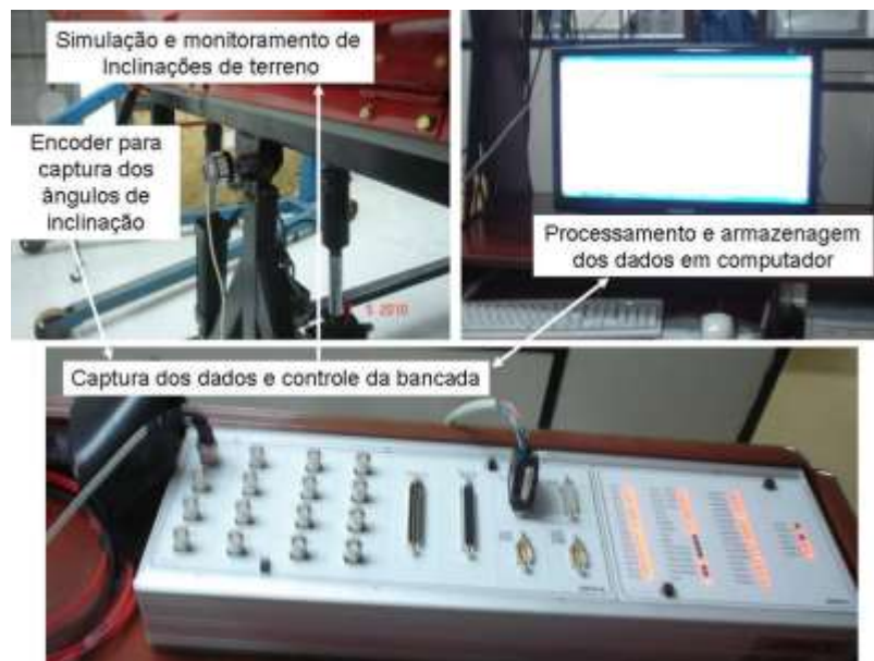
Figura 6 – Instrumentalização do protótipo concebido para a unidade de controle de nivelamento em avaliação em no laboratório.
