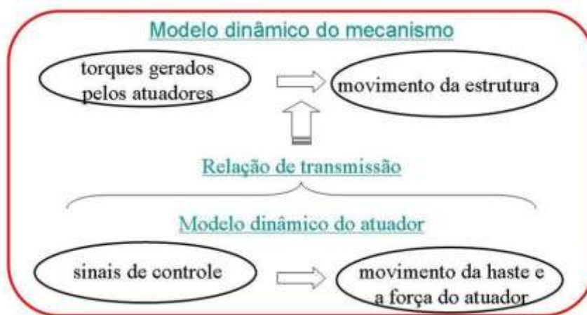
Figura 4 – Diagrama esquemático representando o acoplamento dinâmico entre os modelos do atuador e do mecanismo.
