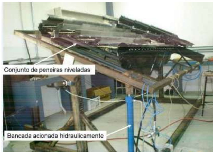
Figura 9 – Fotografia mostrando os testes do protótipo do controle automático de nivelamento por acionamento pneumático em avaliação no laboratório com a bancada com acionamento hidráulico.
