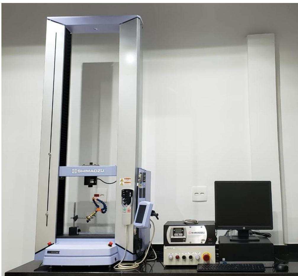
carregamentos. Fabricado pela empresa japonesa Shimadzu (foto), o equipamento USF-2000A realiza ensaios de fadiga nos quais 107, 109 e 1010 ciclos de carregamento são alcançados em nove minutos, 14 horas e 6 dias, respectivamente; enquanto que equipamentos convencionais (100 Hz) atingem os mesmos ciclos em 1 dia, 4 meses e 3 anos, respectivamente.
