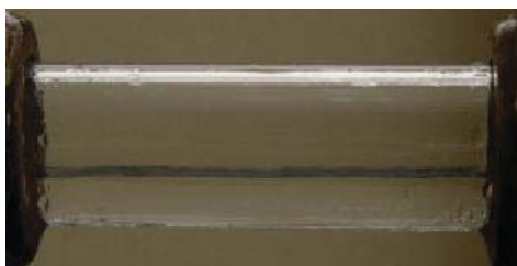
Figura 8: Fotografias do escoamento de R-134a ( T_{sat} = 5\text{ }^{\circ}\text{C} , D = 0,0158\text{ m} , G = 50\text{ kg/m}^2\text{ s} , \Phi = 5\text{ kW/m}^2 e x: 0,30 ).
