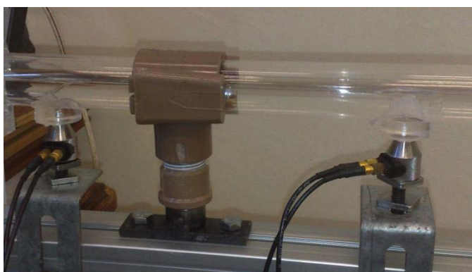
Figura 3 - Foto dos transdutores de ultrassom instalados na seção de testes
