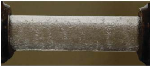
Figura 2: Fotografias do escoamento de R-134a ( T_{sat}=5\text{ }^{\circ}\text{C} , D=0,0158\text{ m} , G=200\text{ kg/m}^2\text{ s} , \Phi=10\text{ kW/m}^2 e x=0,81 ).
