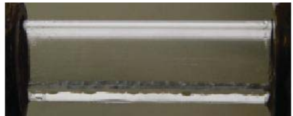
Figura 10: Fotografias do escoamento de R-134a ( T_{sat} = 5\text{ }^{\circ}\text{C} , D = 0,0158\text{ m} , G = 25\text{ kg/m}^2\text{ s} , \Phi = 5\text{ kW/m}^2 e x: 0,83 ).
