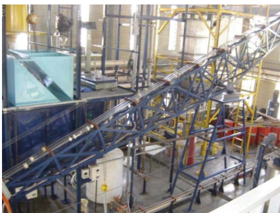
Fig. 3 – Foto da seção de testes Oleoduto Direcional do NETeF.
