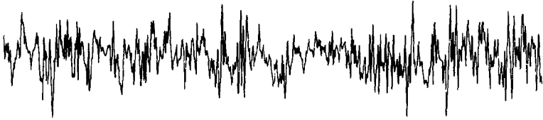
Figure 3.1: Sinal típico de flutuações de velocidade em um escoamento turbulento; adaptado de Tritton (1988).
