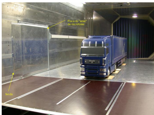
Figura 15: Detalhes da placa de array de microfones.
