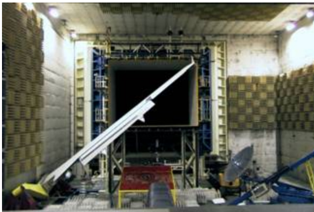
Figura 11: Túnel da DNW , ensaio de uma semi-asa em escala real com hiper-sustentadores. Nota-se na figura um “array” de microfones para quantificar o ruído e o “Microphone Mirror” para localizar fontes de ruído.
