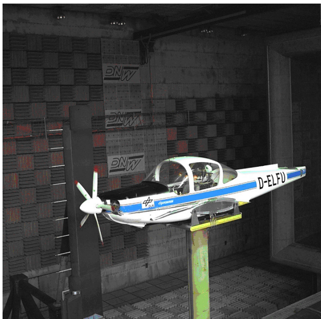
Figura 13: Câmara de ensaios do túnel NWB para ensaios de identificação de fontes de ruídos.
