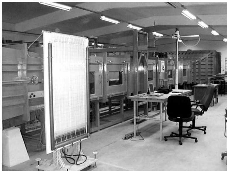
Fig. 4. Túnel de vento “Prof. Joaquim Blessmann” do Laboratório de Aerodinâmica das Construções, UFRGS.
