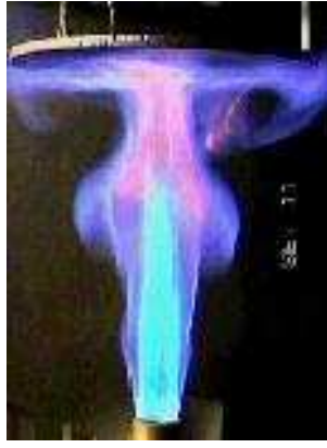
Figura 7.9: Chama turbulenta pré-misturada estabilizada em geometria de ponto de estagnação.
