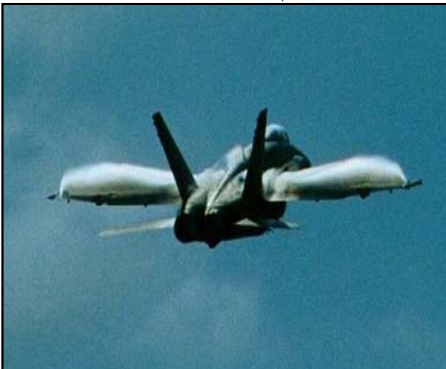
Figura 13. Condensação do ar úmido no extradorso de asas de sustentação.
