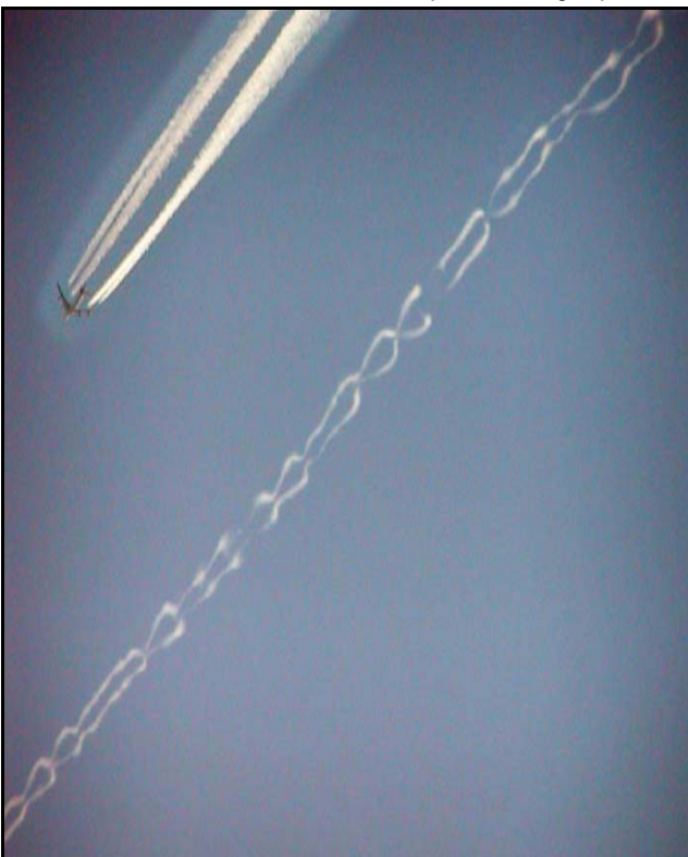
Figura 14. Rastros de condensação deixados por aeronaves em vôo e instabilidades de Crow.
