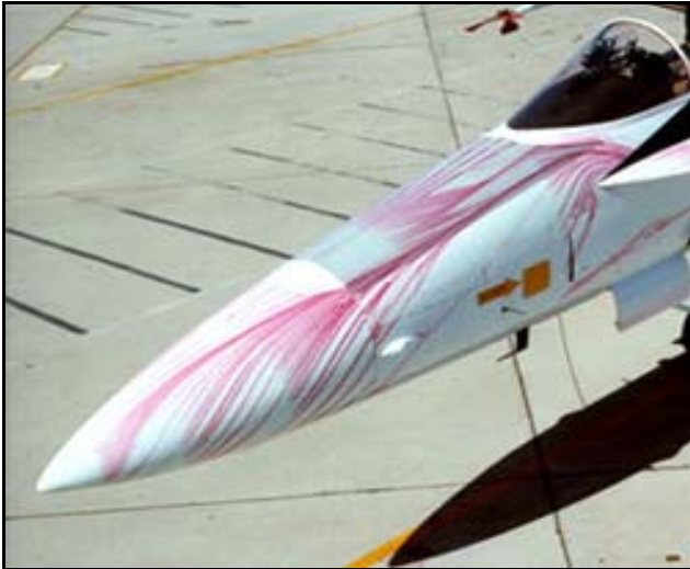
Figura 21. Visualização do escoamento em torno de aeronaves, através da deposição de um filme de óleo sobre a fuselagem.
