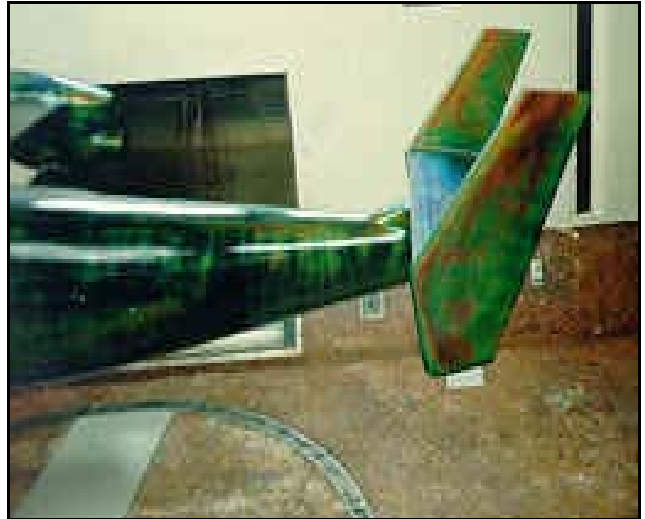
Figura 21. Visualização do escoamento em torno de aeronaves, através da deposição de um filme de óleo sobre a fuselagem.
