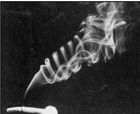
Figura 7. escoamentos visualizados naturalmente, com a presença de fumaça.
