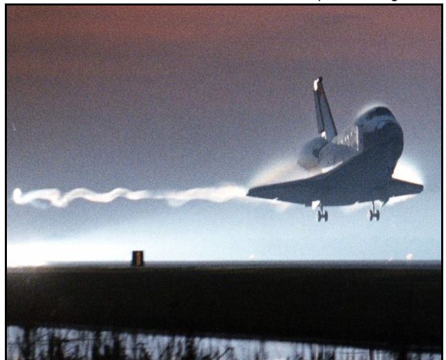
Figura 13. Condensação do ar úmido no extradorso de asas de sustentação.
