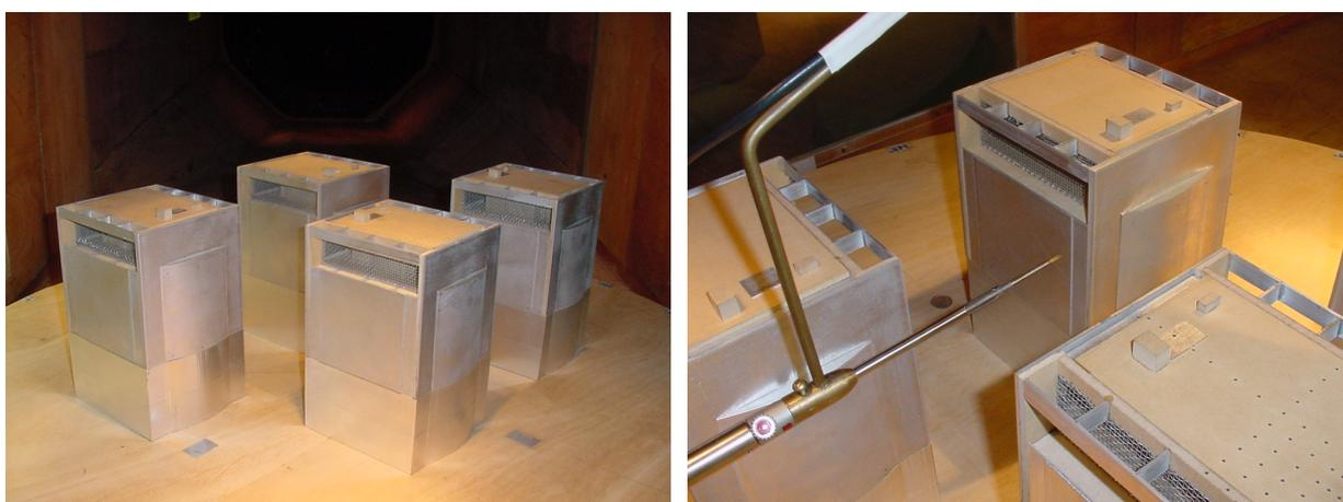
Figura 37. Modelo reduzido do empreendimento *SP Wellness*, para o estudo das condições aerodinâmicas na região dos helipontos (Schettini, Loredou-Souza, 2002).
