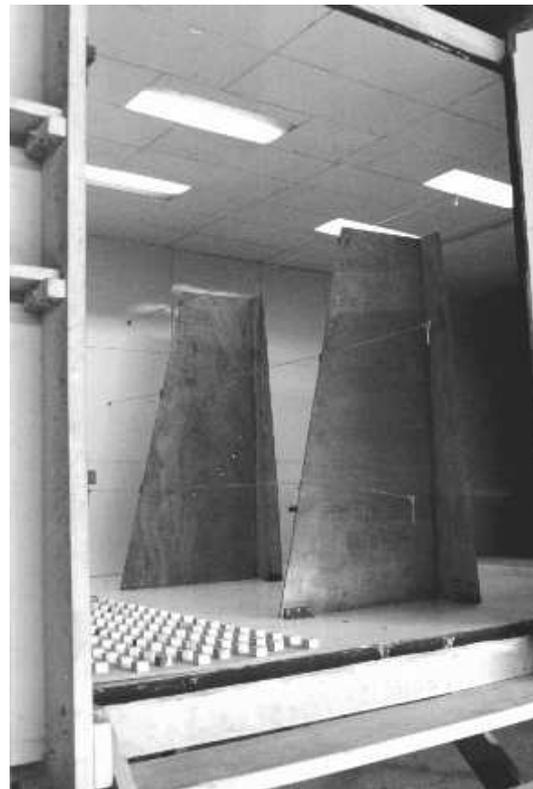
Figura 10. Elementos de rugosidade e simuladores de Standen utilizados no túnel de vento Prof. Jacek P. Gorecki.
