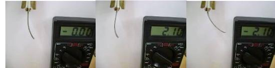
Figura 6: Membrana submetida a uma onda quadrada com amplitude de 2,1V e frequência de 0,2Hz.
