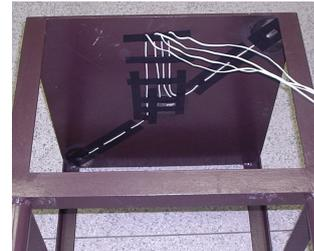
**Figura 1: Plataforma de força e colagem dos extensômetros.**
