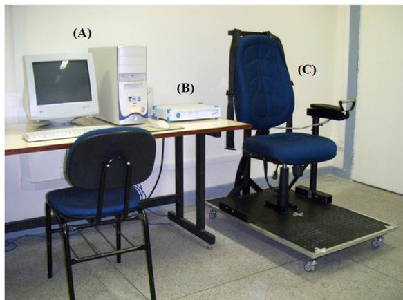
Figura 2 - Detalhe dos elementos do Dispositivo de Medição de Esforços (DME).
