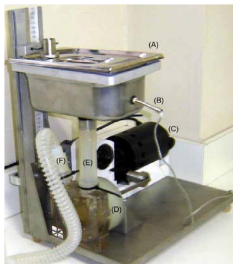
Figura 1: Bancada de Simulação: (A) reservatório, (B) sensor de temperatura, (C) sistema de bombeamento, (D) Câmara ventricular, (E) entrada e (F) saída.
