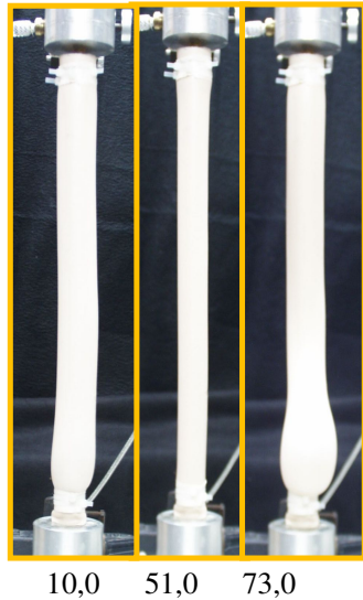
Figura 3: Seqüência da pressurização do tubo de silicone sem tração, pressões em (mmHg).
