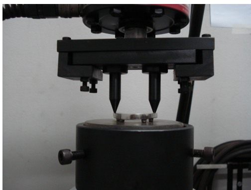
Figura 2: Dispositivo de aplicação de carga na máquina MTS.
