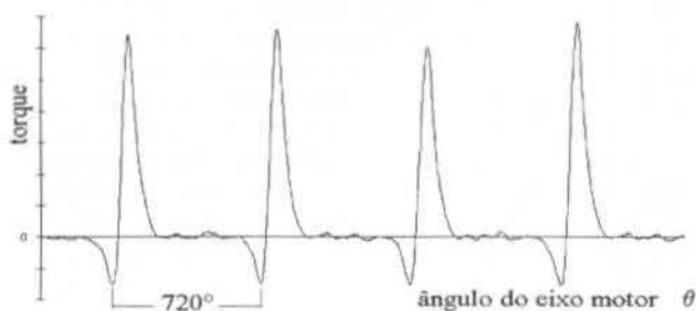
Figura 2- Torque devido ao gás em um cilindro, em função do ângulo do eixo motor.
