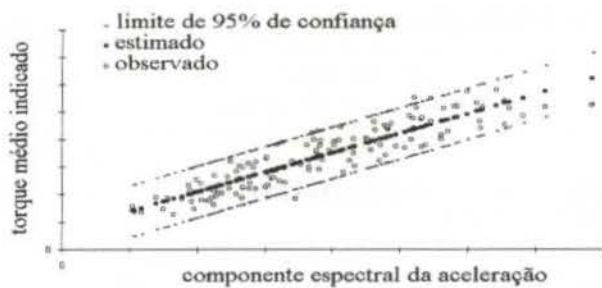
Figura 6- Torques médios indicados em função das componentes espectrais da aceleração no dobro da frequência de explosões.
