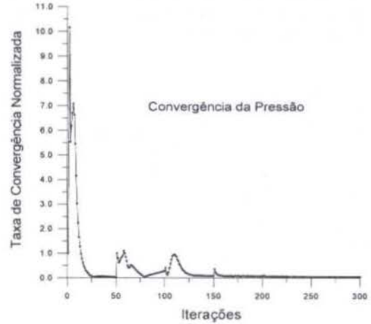
Figura 8 - Taxa de convergência da pressão em função do número de iterações para a simulação tridimensional.
