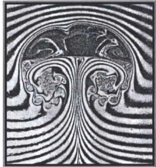
Figura 1. Escoamento em transição em torno de uma bolha (Figura retirada de Couder et al. , 1989).
