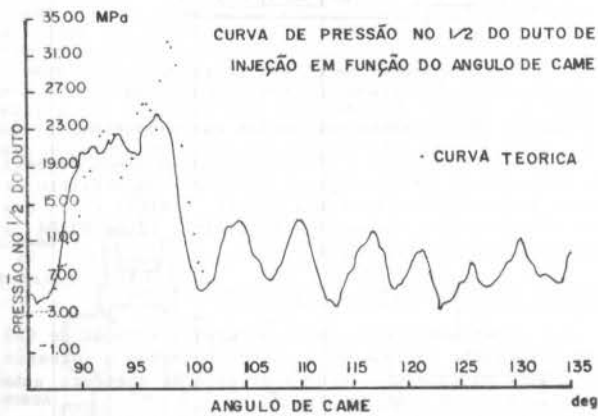
Figura 8 - Comparação de resultados teórico e experimental.
