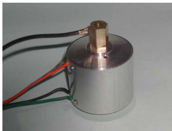
Figura 2. Reator dinâmico sem (esquerda) e com acelerômetro acoplado (direita)
