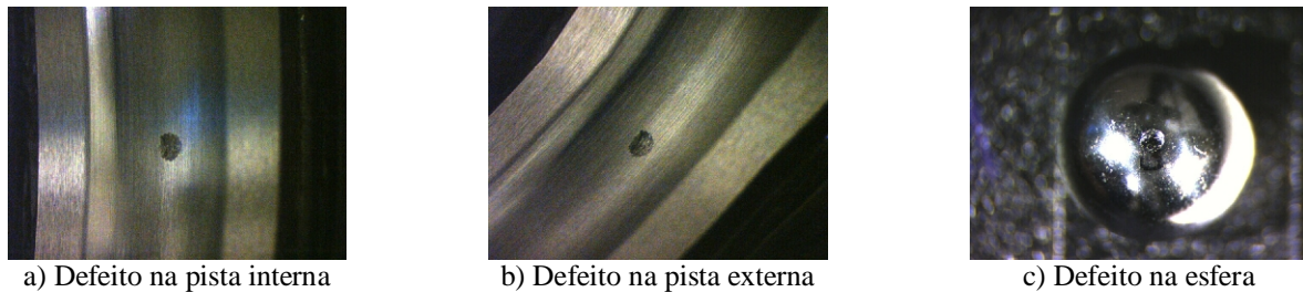
Figura 2. Falhas induzidas nas pistas e esfera do rolamento
