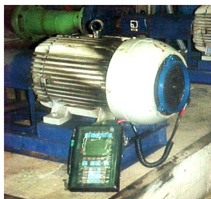
Figura 7. Medição em campo com a bobina CSI.
