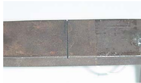
Figura 4. Detalhe da falha introduzida.
