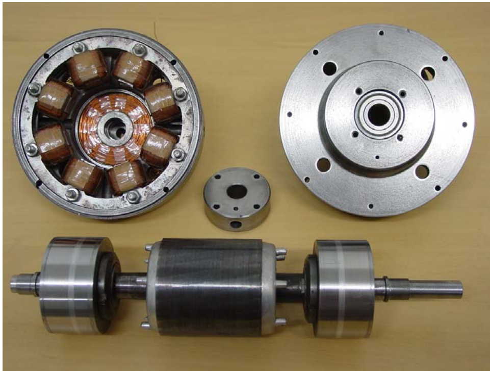
Figura 6. Foto de conjunto das peças, com os estatores, radial e axial, montados na tampa esquerda, o rolamento de segurança na da direita e os rotores dos mancais montados no eixo do motor. No centro, tampa auxiliar para o sensor contador de rotação.
