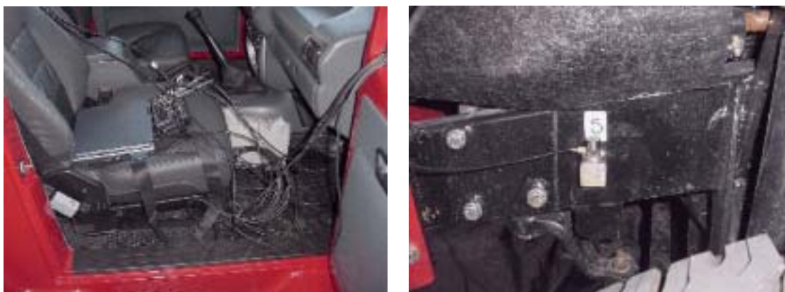
Figura 5. (a) Computador portátil e placa de aquisição sobre o banco de passageiros dianteiro; (b) Acelerômetro montado em cubo metálico colado no chassi.
