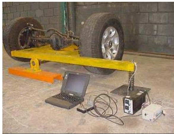
Figura 1. Instrumentação usada no ensaio para determinação do momento de inércia.
