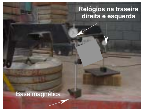
Figura 5: Relógios comparadores instalados na extremidade traseira do chassi.
