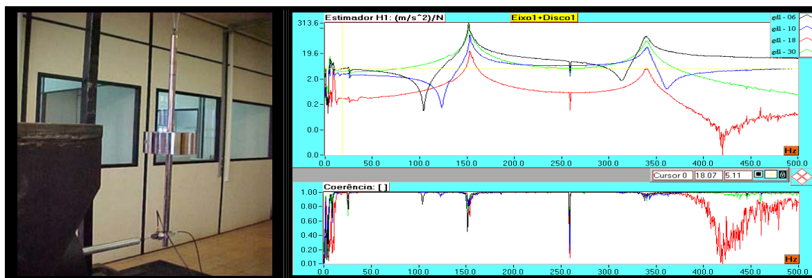
Figura 6. Montagem experimental, Funções de transferência e coerências experimentais para o Rotor (eixo e disco).
