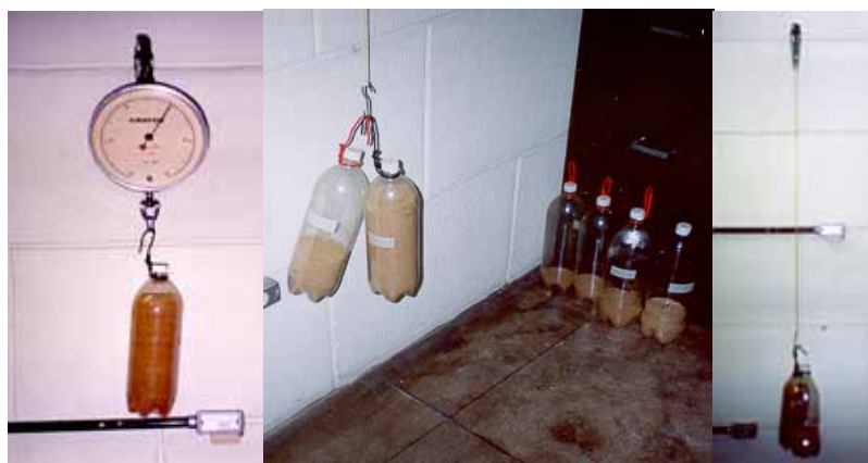
Figura 8 Ensaio de tração realizado com a borracha (thera-tubing amarelo)
