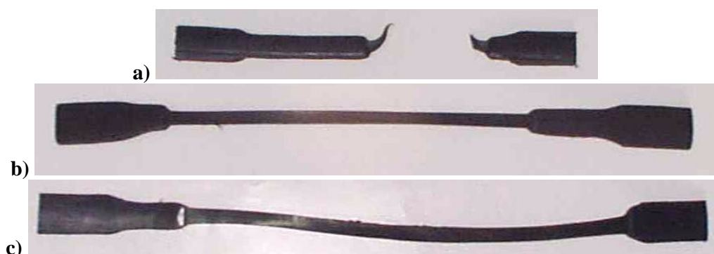
Figura 8. Corpos de prova elaborado com a amostra de material das camadas do cabo após de ensaiados a tração
