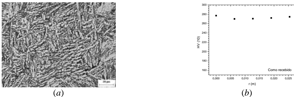
Figura 2 – (a) Micrografia do material como recebido - martensita revenida. Ataque: Nital 2%; (b) Perfil de dureza.
