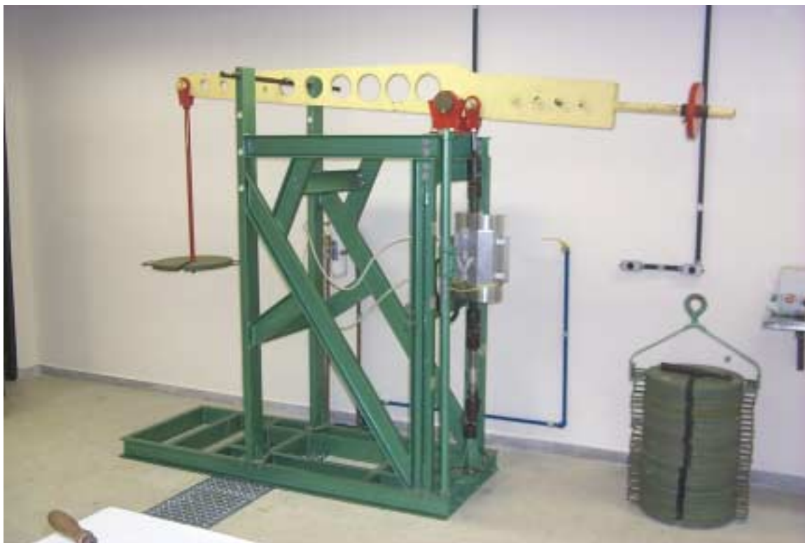
Figura 1 - Máquina de fluência construída no CDTN/CNEN usando a técnica de peso morto.
