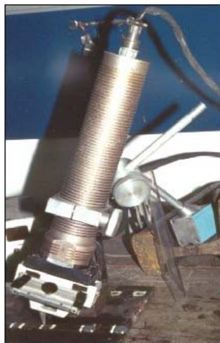
Figura 1. Equipamento portátil de medições de tensões residuais RAYSTRESS em uma junta de topo soldada do material API 5L X60.
