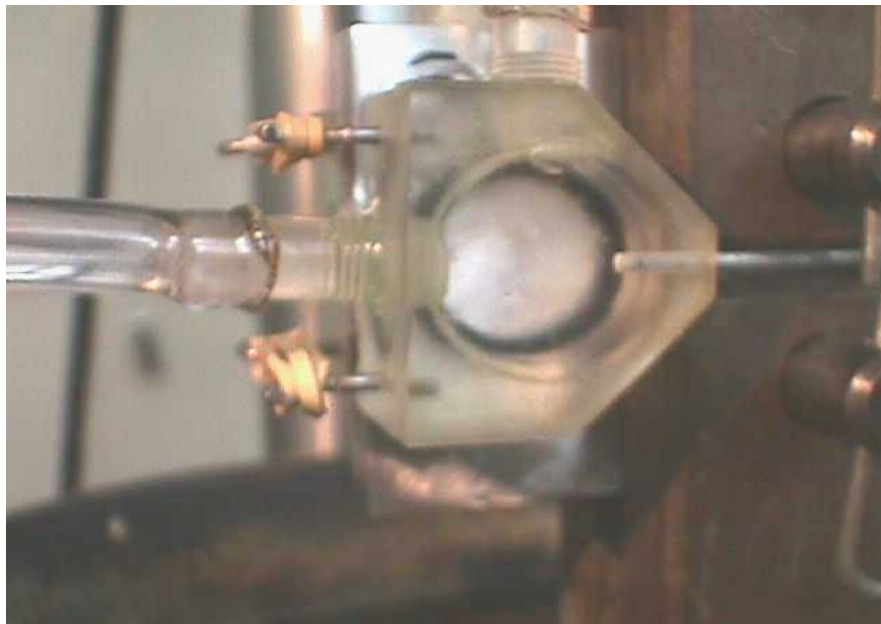
Figura 2. Foto da célula em acrílico montada no corpo de prova.
