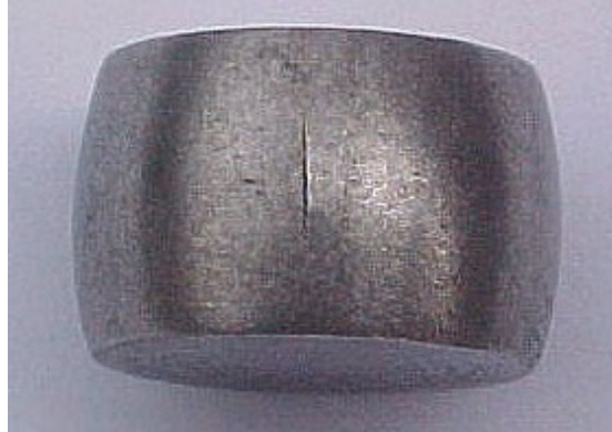
Figura 3. Trinca no corpo de prova do ensaio de compressão
