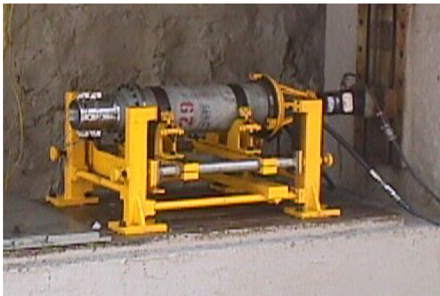
Figura 2. Banco de Ensaio para Motor Foguete a Propelente Sólido.
