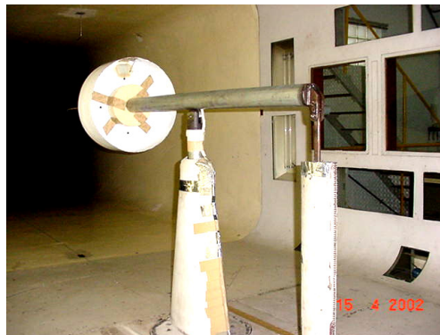
Fig. 2. Vista traseira do modelo montado na seção de ensaios com mastros e carenagens.
