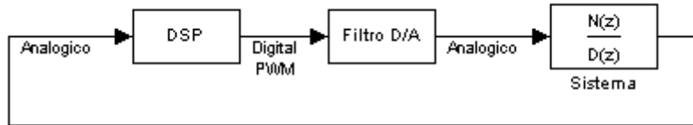
Figura 5. Diagrama de blocos da entrada e saída de sinais no DSP.
