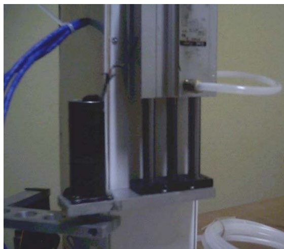
Figura 8. Cilindro e motor DC de acionamento da primeira articulação
