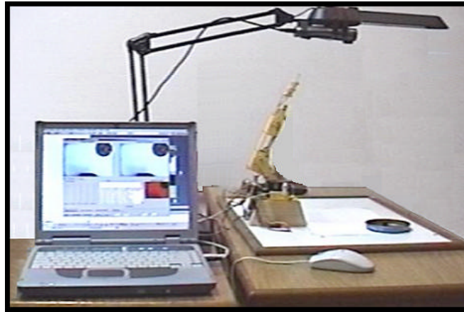
Figura 2 - Protótipo desenvolvido para o sistema de visão robótica
