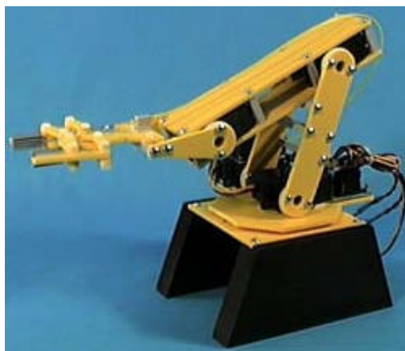
Figura 1 - Manipulador robótico didático Lynx 5
