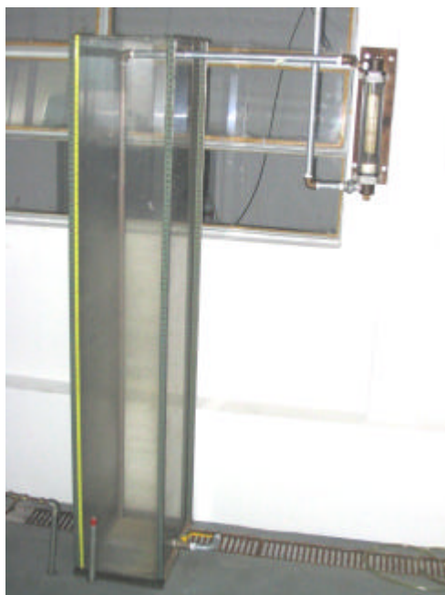
Figura 3 – Rotâmetro para medição da vazão de água e depósito de secção retangular com escala.
