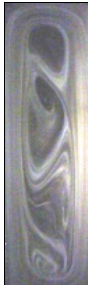
Figura 11. Visualização do escoamento utilizando a técnica da fumaça.
