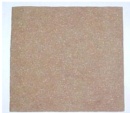
Fig.3 - Manta de fibra da casca do coco.
